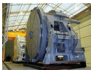
Кабельная машина барабанного типа на 40 тонн
