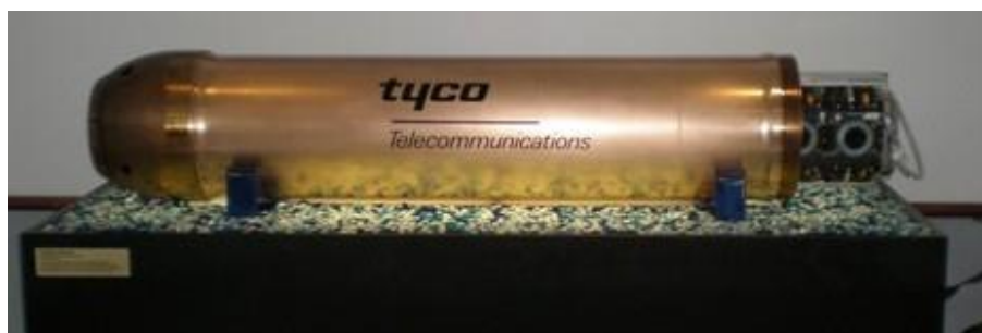
Рисунок 13 – Общий вид подводного оптического усилителя (производство Tyco Telecommunications) [30]
