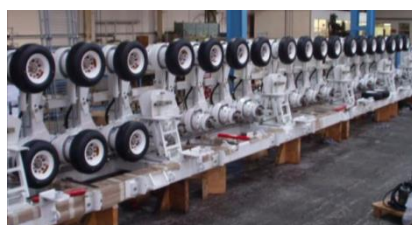
Линейная кабельная машина усилием 20 тонн
