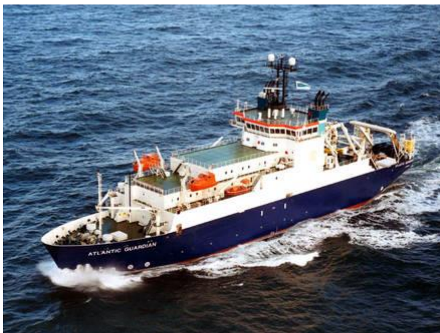
Рисунок 30 – Atlantic Guardian - судно для укладки и ремонта подводных кабелей
